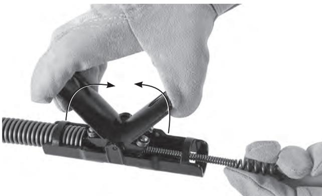
図5 - ケーブルを AUTOFEED® アッセンプリに通す
