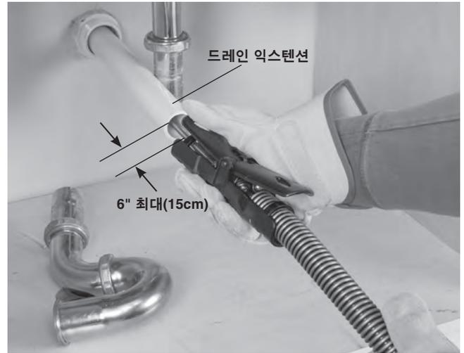
그림 7 - AUTOFEED 장치로부터 6"(15cm) 이내로 드레인을 연장하는 방법 예.
