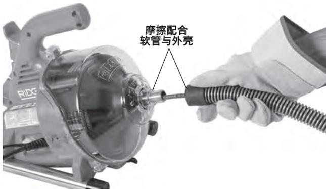
图 4 - 将钢索穿进导管
