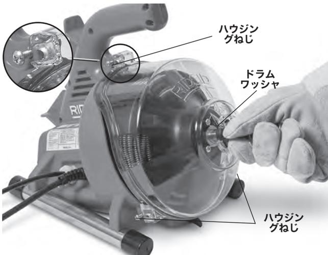
図 13 – 排水管清掃機を開ける
