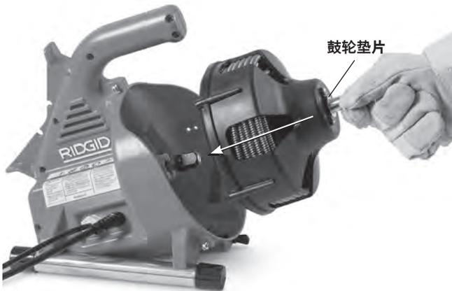
图 16 – 将鼓轮插入机器
