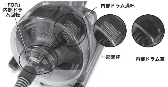
図10 - 内部ドラム内のケーブルの監視
