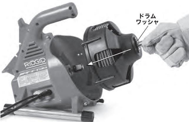
図 16 - ドラムを機械に差し込む
