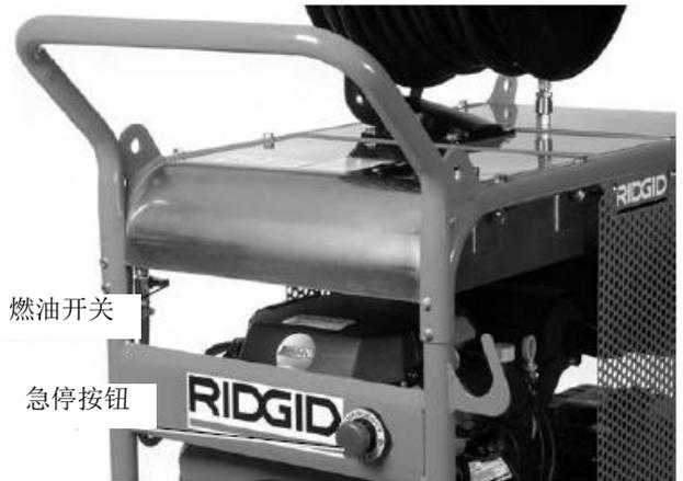
图 16B –控制装置
