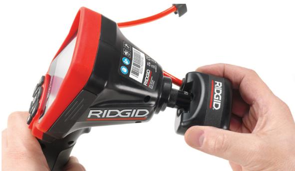
图9 ~ 连接micro CA-300摄像头
