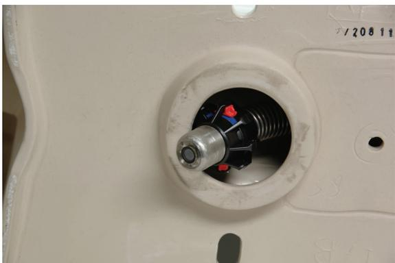
图17 ~ 带球形导向的摄像头位于弯道处
