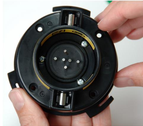
图6 ~ 破损的触针
