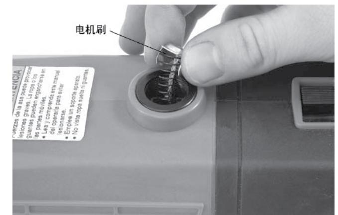
图18 电机刷安装
