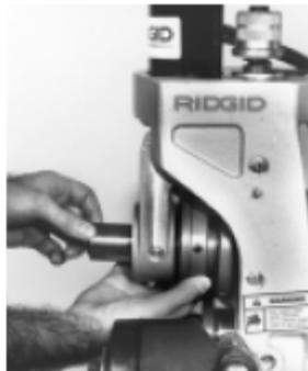
图12 — 拆下滚沟轮及其轴
