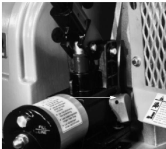
图4 — 关闭泵的释放手柄
