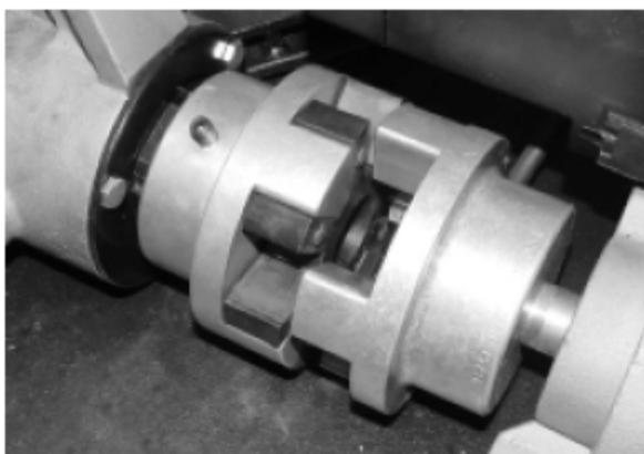
图16 — 拆下轴承、固定螺母和前半部联轴器
