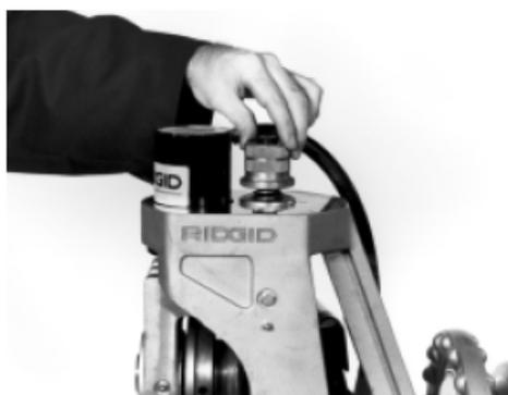
图8 — 转动调节滚沟深度旋钮，与机器表面接触
