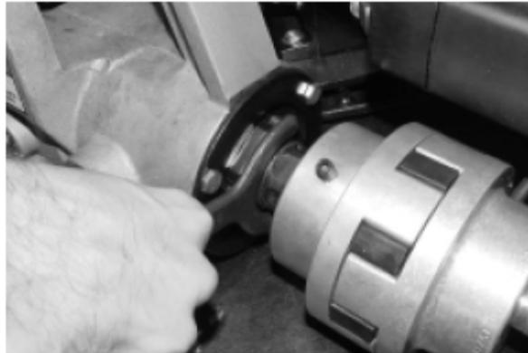
图14 — 松开和拆下驱动轴固定螺母
