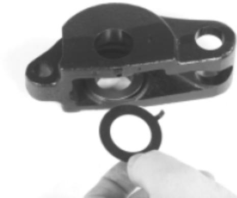
图18 — 插入带有突出物的止推垫圈
