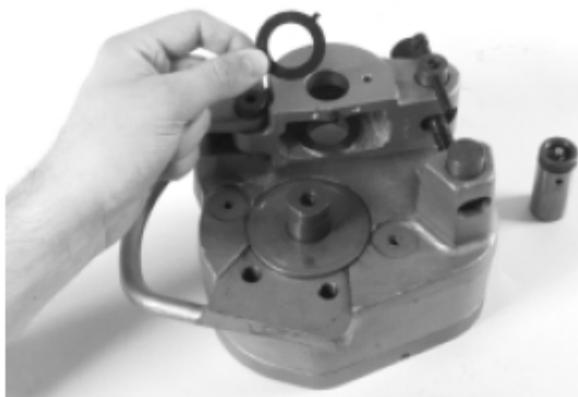
图10 — 安装止推垫圈
