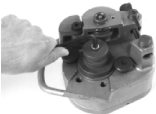
图8 — 拆下驱动轮螺母
