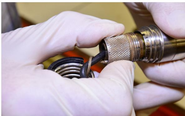
4. 在您将摄像头旋入到弹簧上的过程中，探测器会发生扭曲。逆时针旋转摄像头一圈以抵消扭曲，然后将摄像头旋入到弹簧上。
