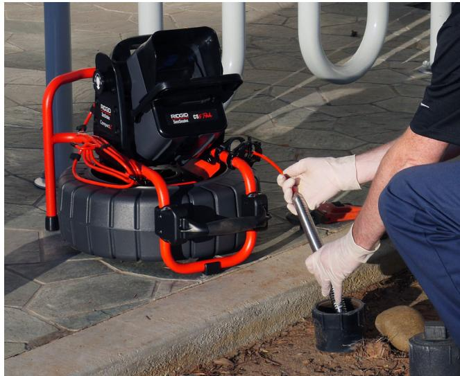
Compact2 配有一根 30米[[100英尺] 长的减摩推索和一部 25毫米[1英寸]的水平校正摄像机，可根据管道直径情况检测直径为 38毫米至 152毫米 [1.5英寸 至 6英寸]的管道。找到管道内监测点后，便可使用 512. 赫兹集成器探测器和接收器来对其定位。
