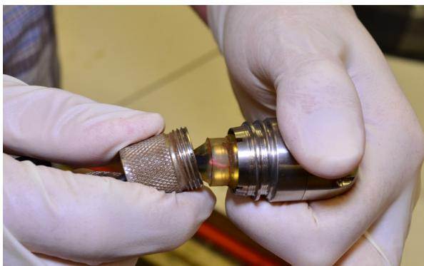
3. 为确保安全线缆最终较为平直，在将摄像头拧到弹簧上时，您需要先将摄像头回拧约  $1\frac{1}{2}$  圈（逆时针回拧）。
