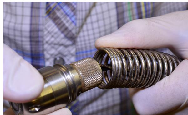
5. 继续将摄像头旋入弹簧，直至弹簧圈末端与摄像头平齐。
