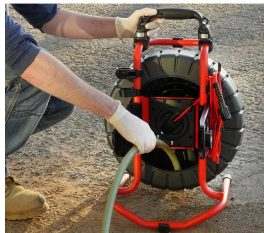
**注意** 高压水清洗可损坏保护鼓轮内部电子设备的密封圈。
