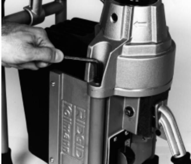
图 11 拆卸卡爪组件示意图
