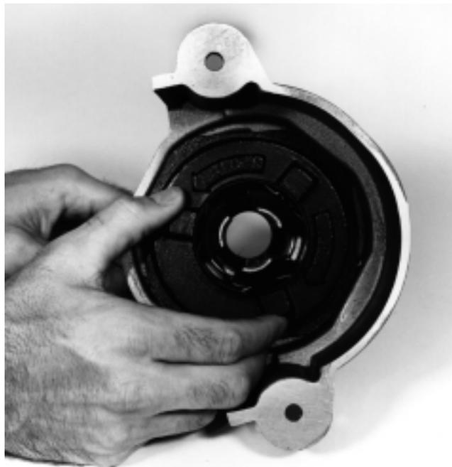
图12 卡爪端盖拆卸
