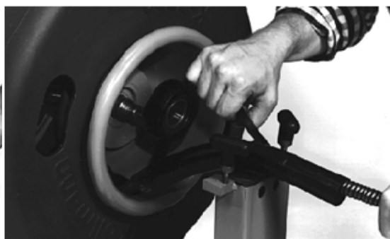
图22 — 拆下导向软管
