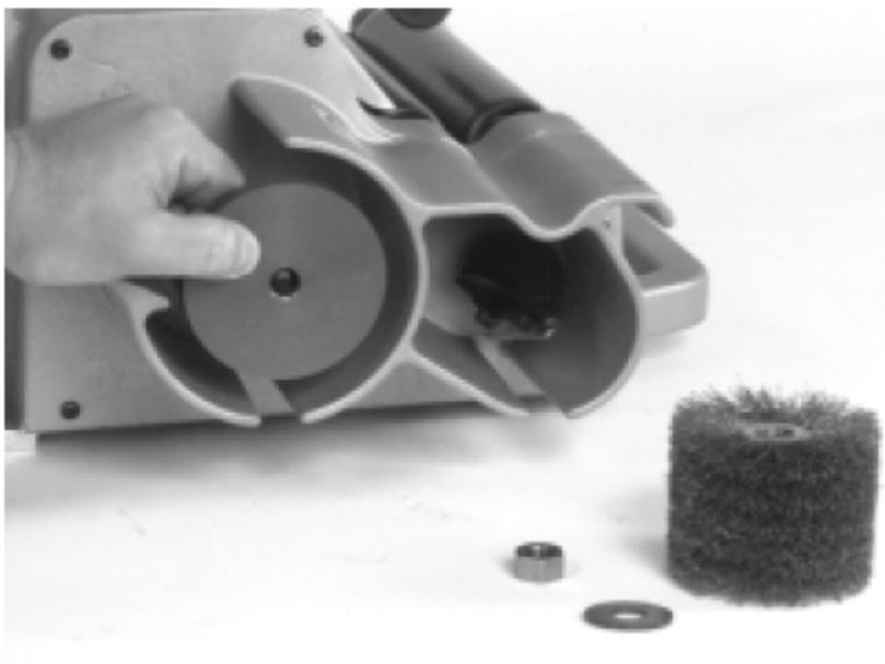
图3 — 安装去毛刺盘片
