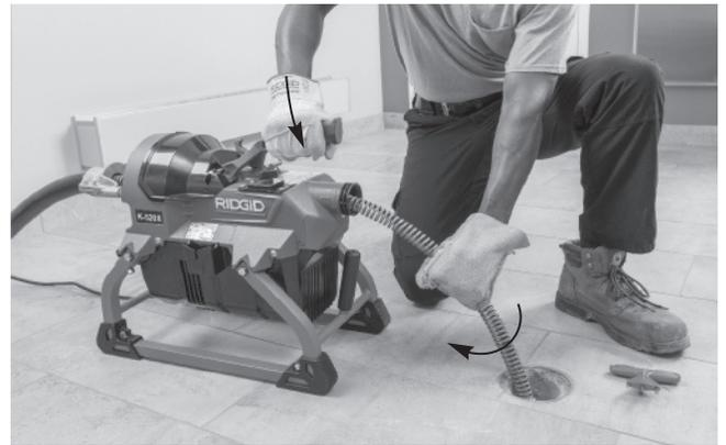
图11A - 离合器啮合、钢索旋转、将钢索送入排水管道中
