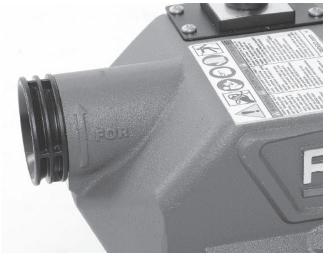
图10 - FOR机器旋转记号
