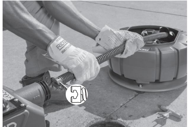
图7 - 将钢索插入机器正面
