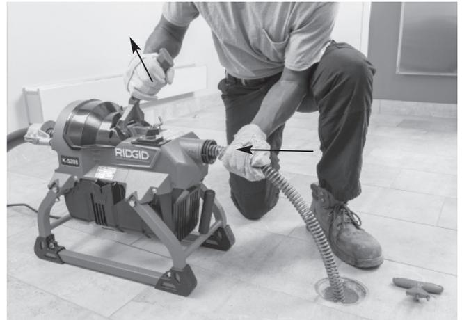
图14B - 离合器松开、钢索不旋转、将钢索送入机器中
