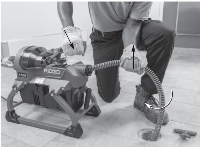
图14A - 离合器啮合、钢索旋转、将钢索从排水管道中拉出
