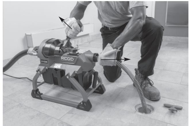
图11B - 离合器松开、钢索不旋转、将钢索从机器中拉出
