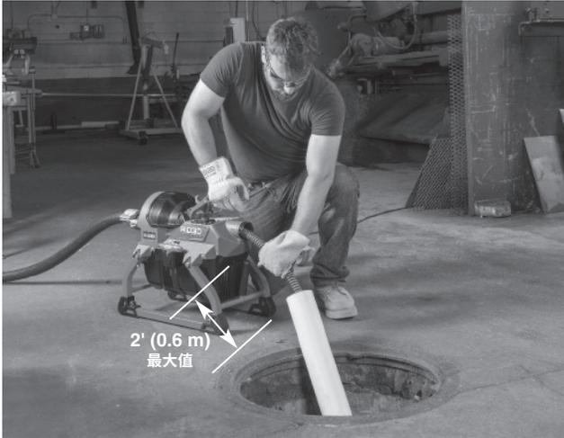
图5 - 延长示例, 使排水管道位于机器钢索出口2' (0.6m)的范围内
