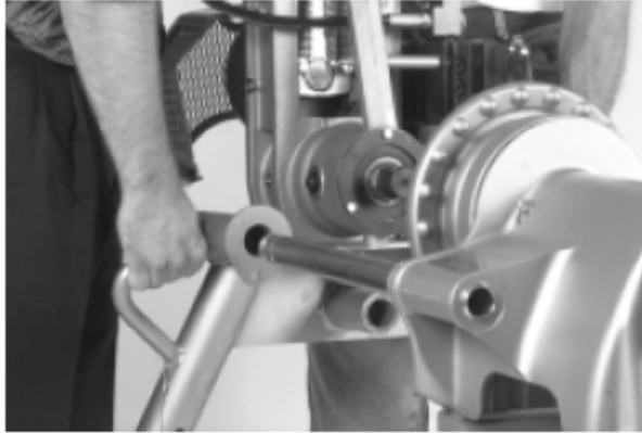
图4 — 把滚沟机滑入到动力驱动设备上的支持臂上
