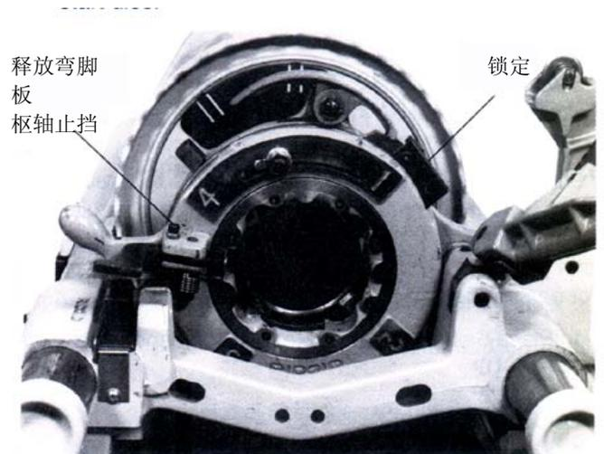
图 15 锁定板定好位，以便进行 NPSM/BSPP 直螺纹作业
