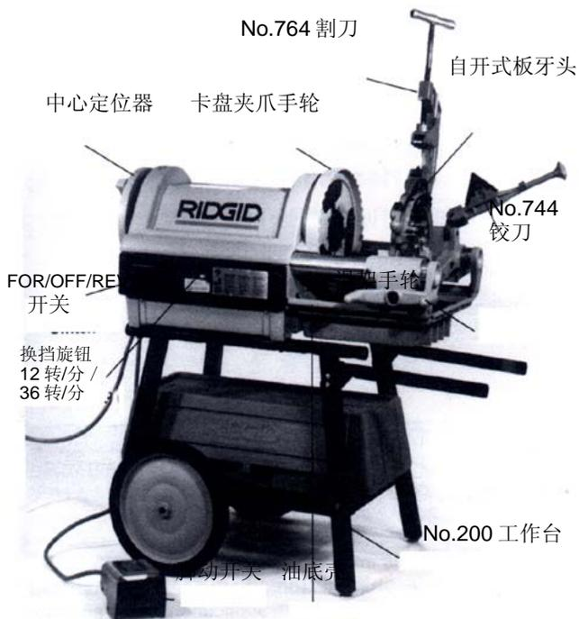
图 4—No.1224 管子及元钢套丝机
