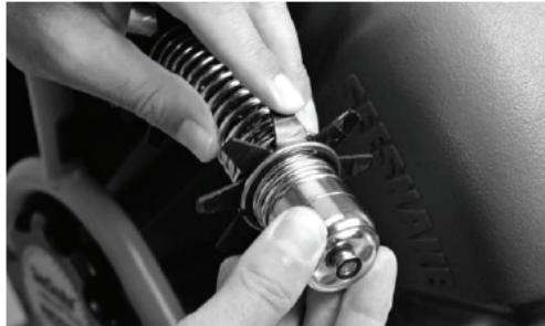
图 13–安装星形导向
