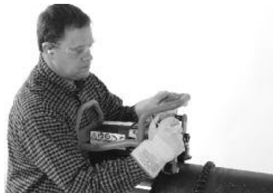
图 10A 用手紧固夹紧螺丝
