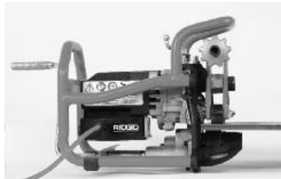
图 9B 在板上安装坡口机
