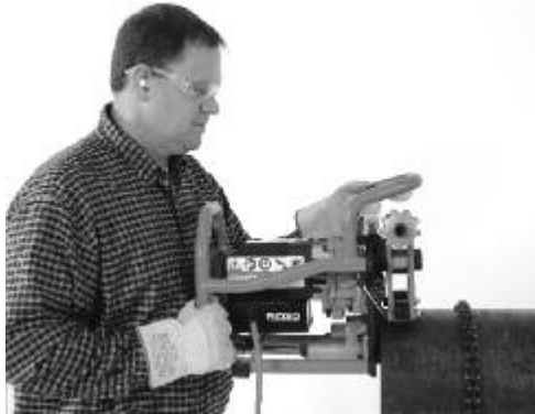
图8A 将坡口机放在管道上
