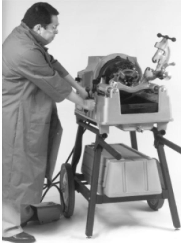
图8 — 535A型自动套丝机套丝
