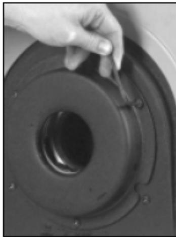
图 18A — 打开后部卡爪罩壳
